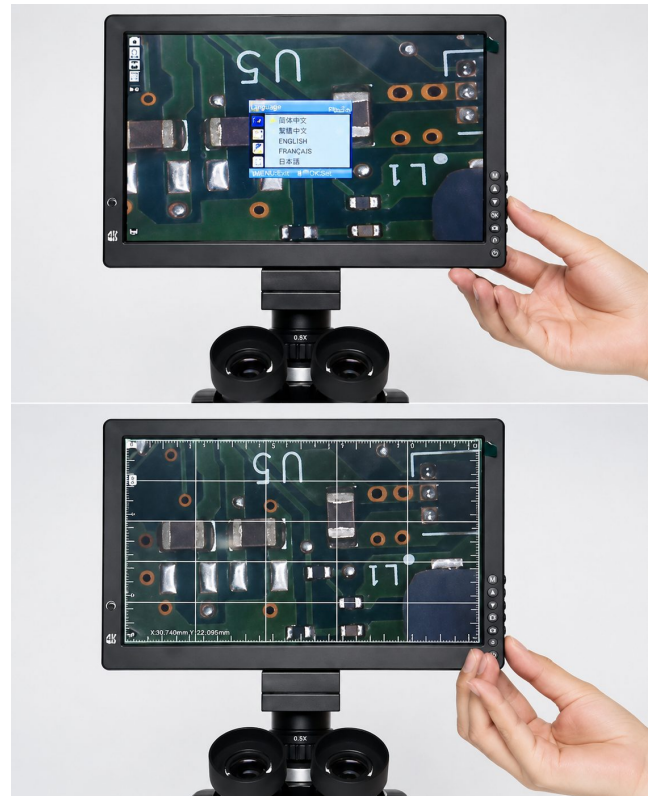
A câmera em uso: o menu de ajustes aberto na tela (acima) e a imagem ao vivo com a grade de medição (abaixo).
